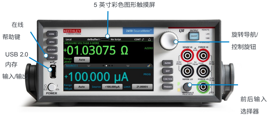
2450 前面板配有高分辨率电容式触摸屏。
